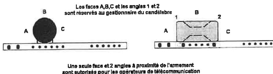
Figure 3 - Positionnement de la traverse télécom
